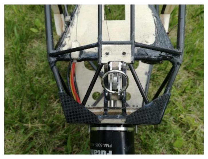
画像212 飛行機曳航用索リリース機構の取付状況 左=側面 右=下面
