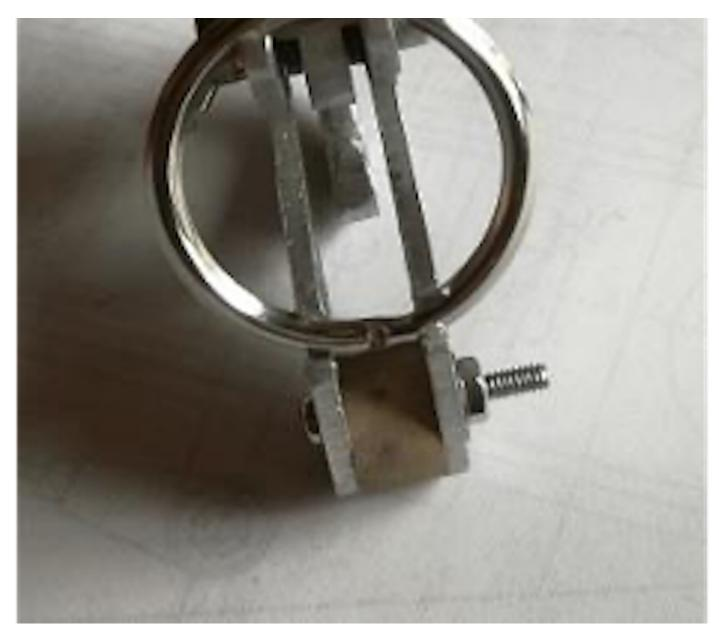
画像211 飛行機曳航用索リリース機構 左=側面 右=下面
