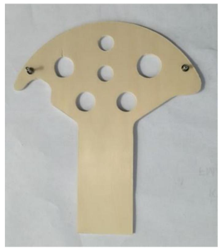
図面53 (左) 三田式3型改1の計器盤形状 | 画像216 (右) 1.6mmシナベニアで作った計器盤
