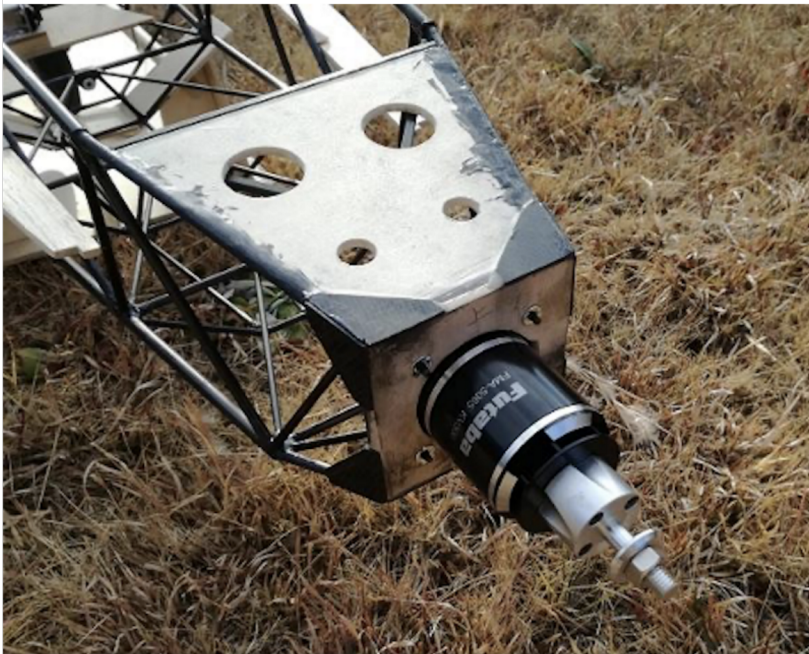
画像127 マウントへのモーター仮取付
