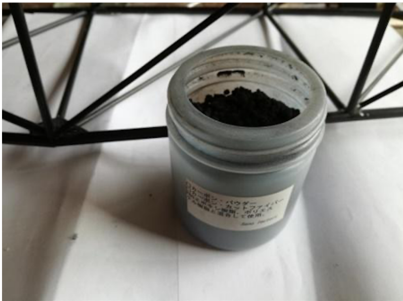
画像123 カーボントラス構造の接着用エポキシ樹脂に混ぜたカーボンパウダー
