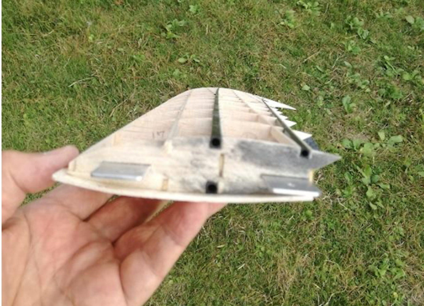
画像103 外翼桁の変形
