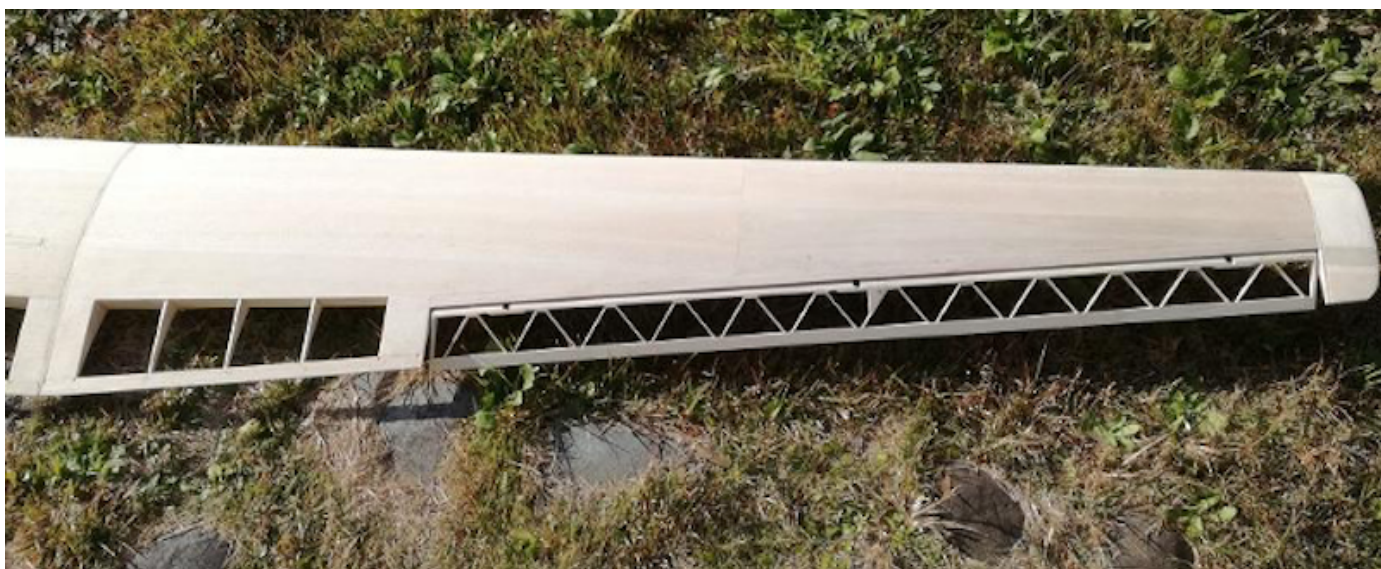
画像109 木地完成した外翼
