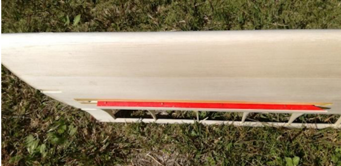
画像101 スポイラー開状態の確認 左＝上側 右＝下側
