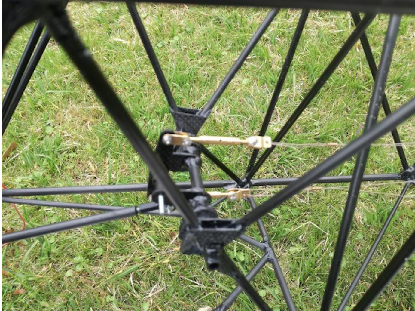
画像89 前側ベルクランク拡大写真
