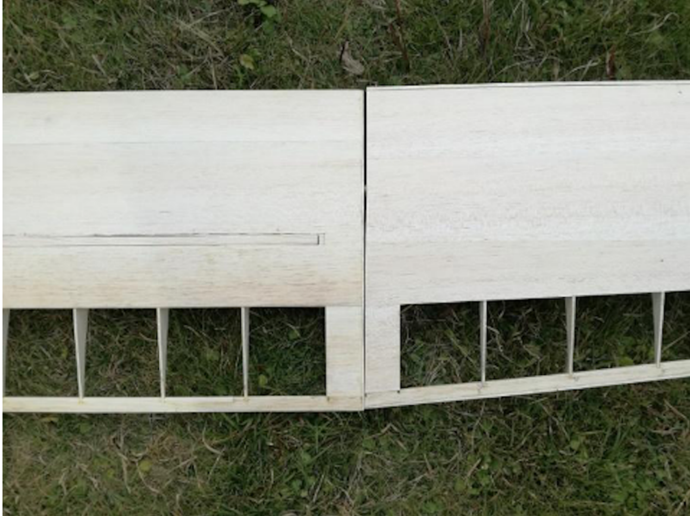
画像107 中央翼と外翼の接続面が合わない！
