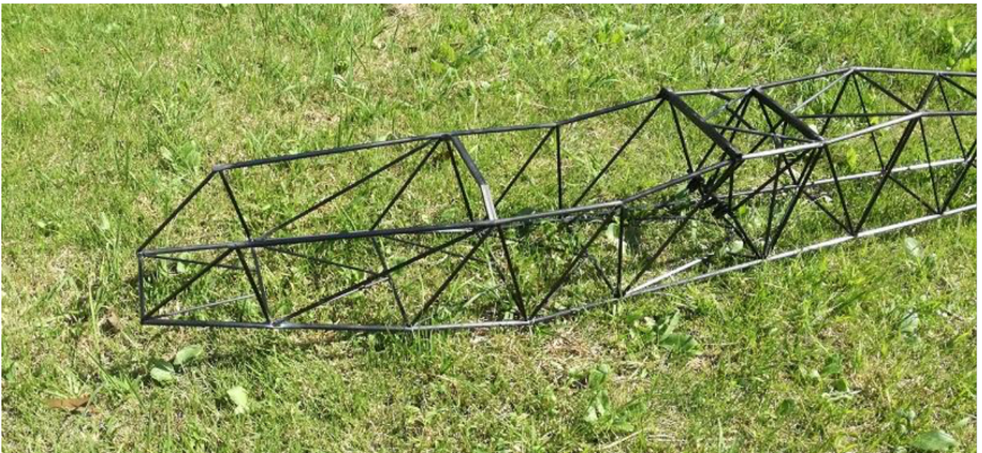
画像78 コクピット部の構造
