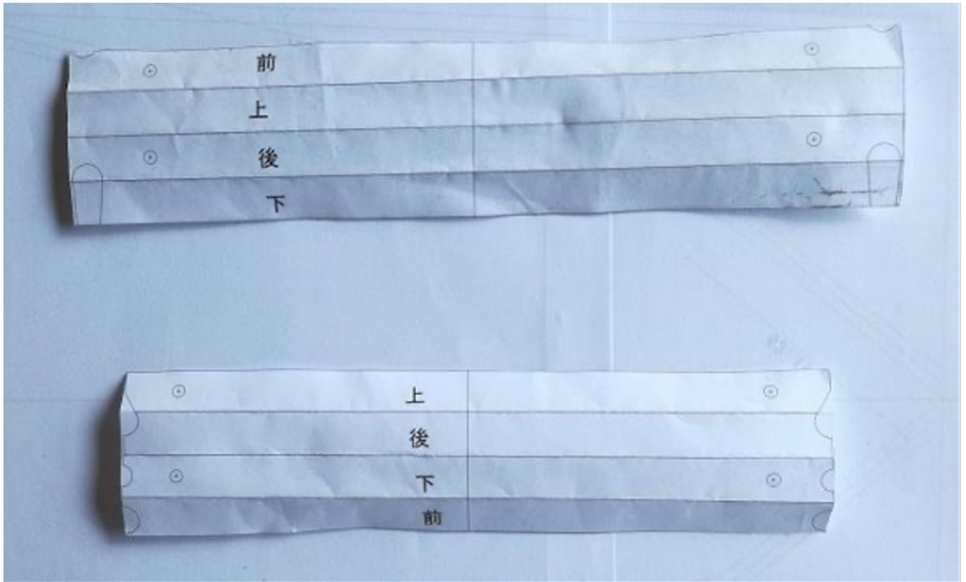
画像69 切り出した主翼取付け横梁の展開図
