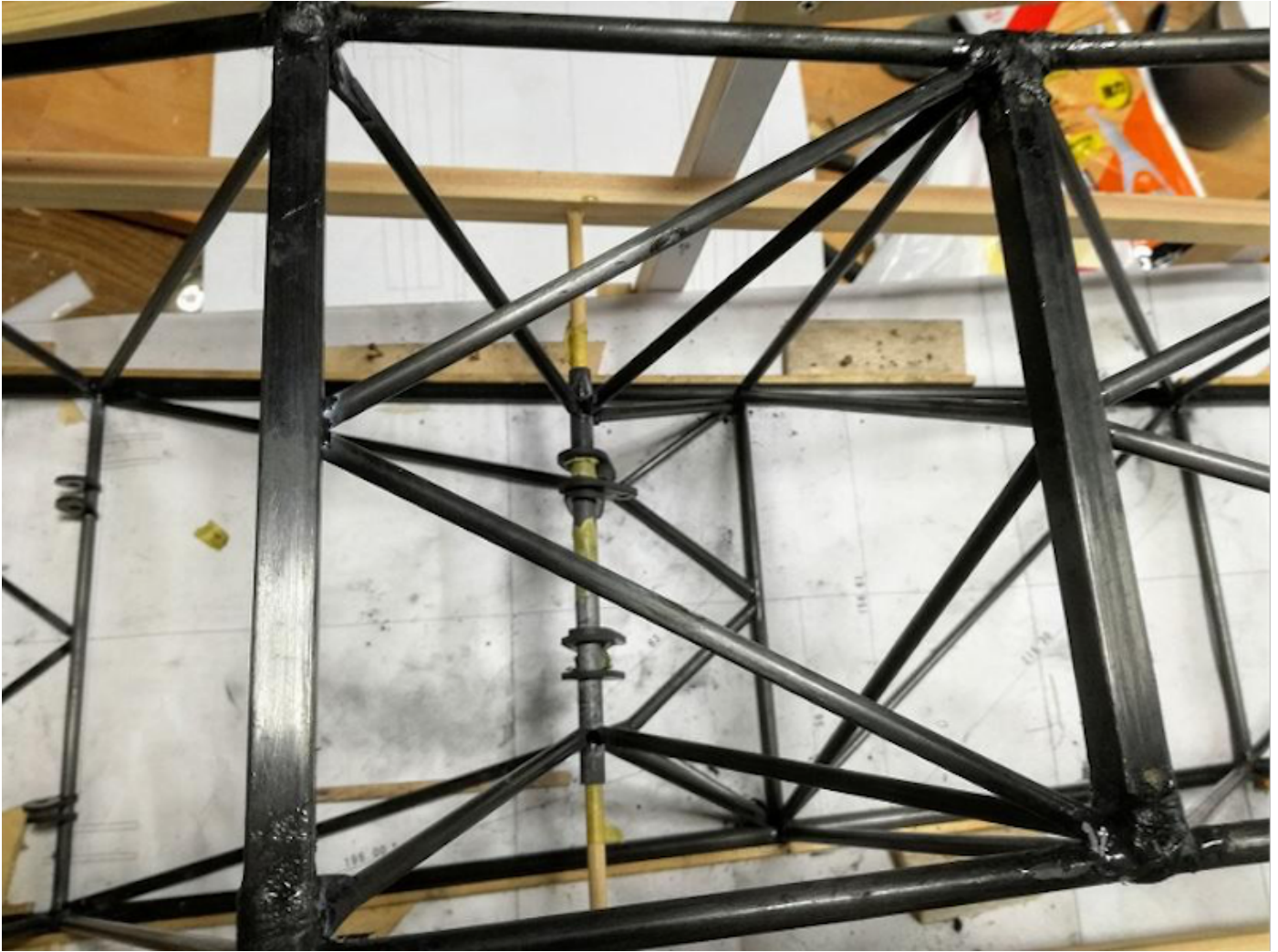
画像74 主脚取付用トラス構造の組立
