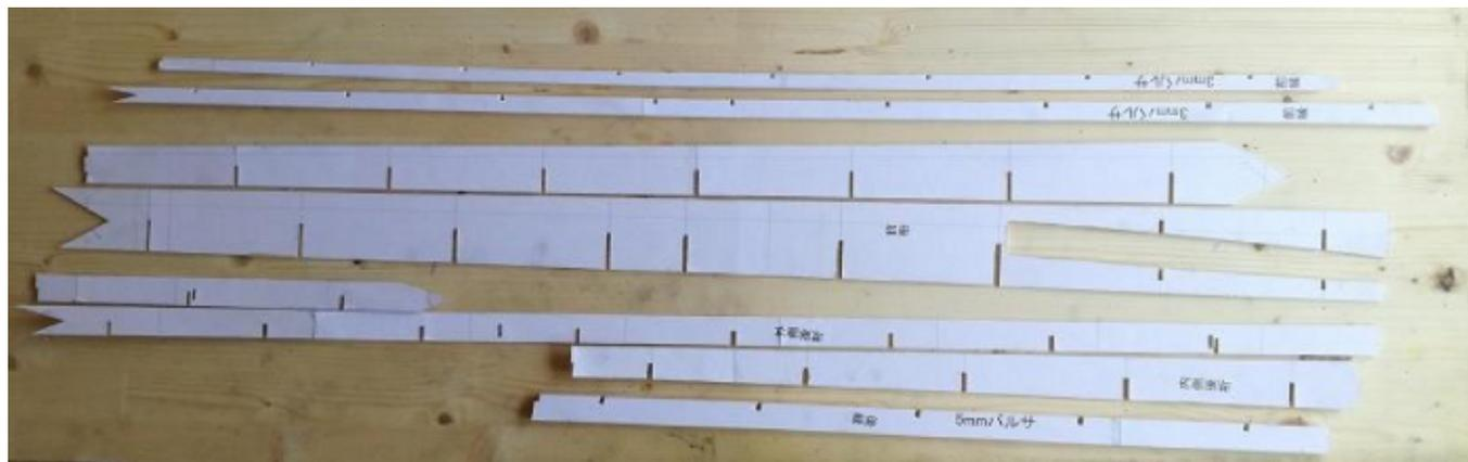
画像42 外翼用桁ウェブと前縁材、後縁材 (片翼分)
