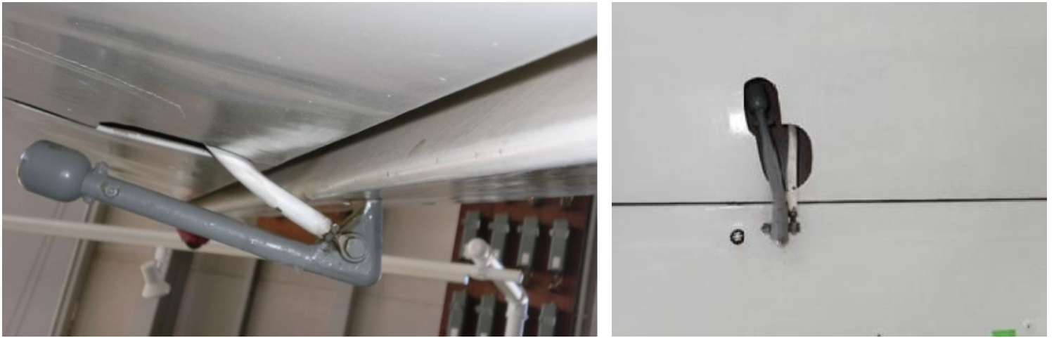
画像54 実機のエルロンカウンターウエイト
