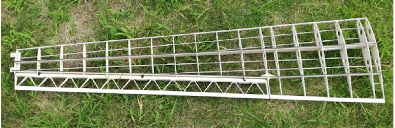
画像50 エルロンの取付チェック
