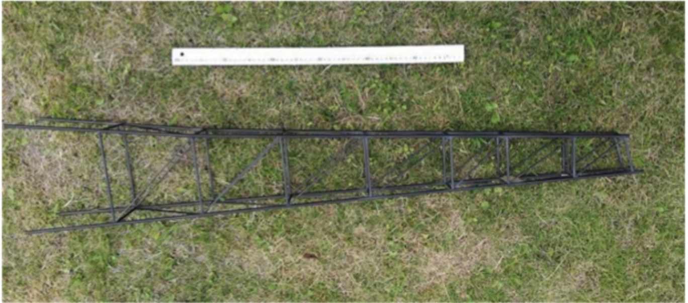
画像32 組みあがった後部胴体主要トラス構
