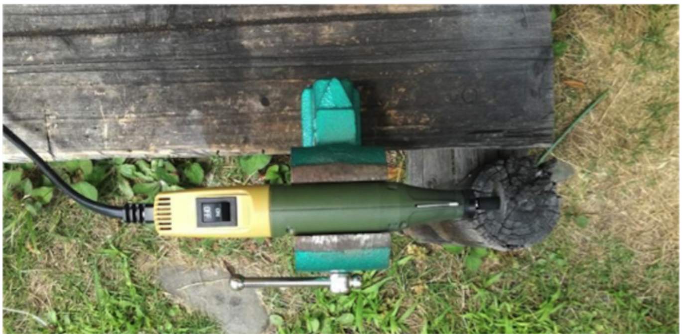
画像29 カーボンパイプ切断用ミニルーター
