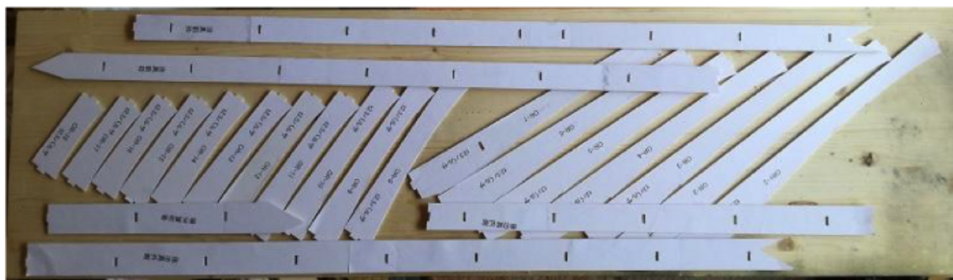
画像43 外翼組立治具部品 (片翼分)
