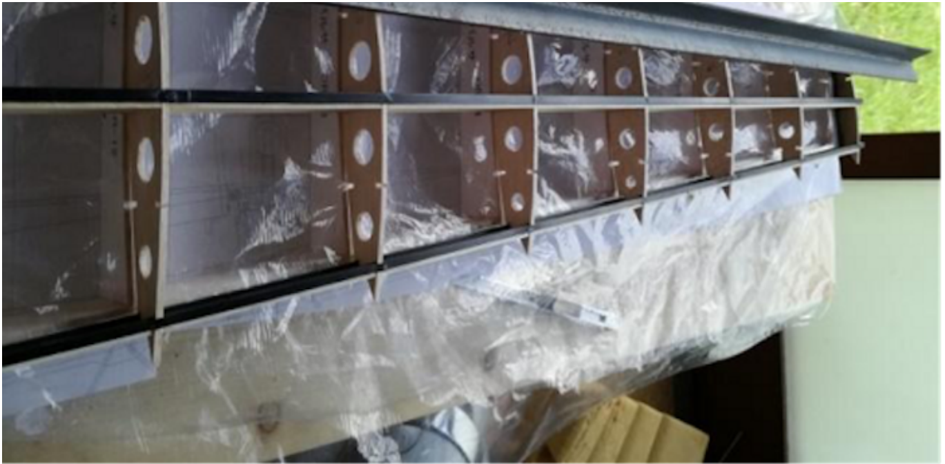
画像46 角度調整が完了した外翼リブ組立
