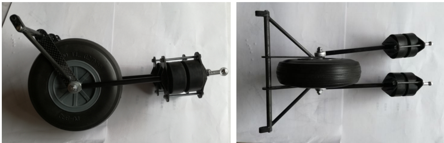
画像53 完成した主脚組立
