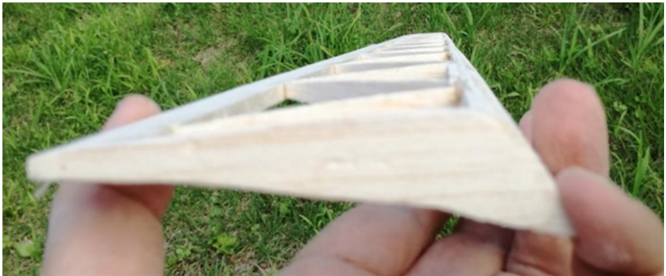
画像36 エルロンリブ組み立ての精度チェック
