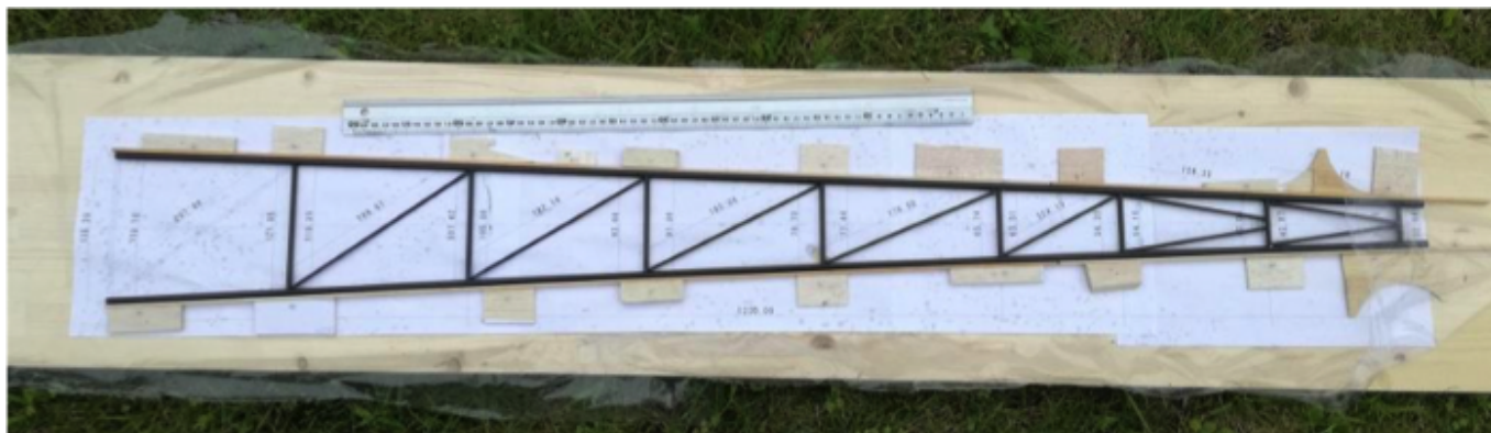
画像30 後部胴体上面パネルの製作風景
