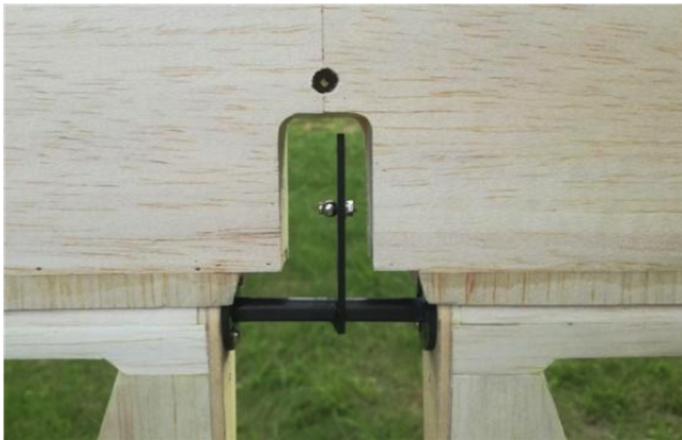
画像28 エレベータ連結部
