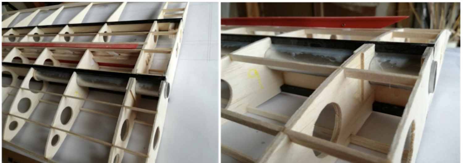
画像13 接着完了後の中央翼リブ組み立て
