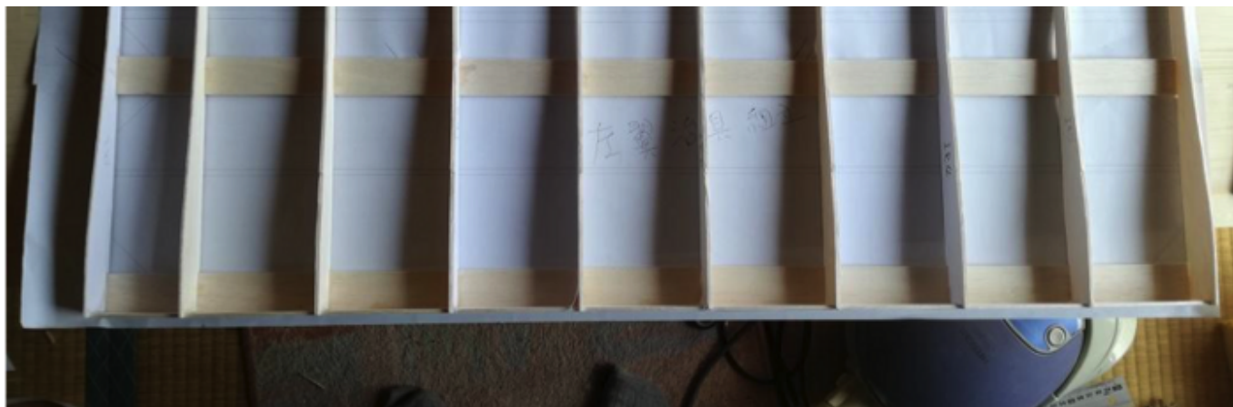
画像9 組みあがった中央翼組立治具
