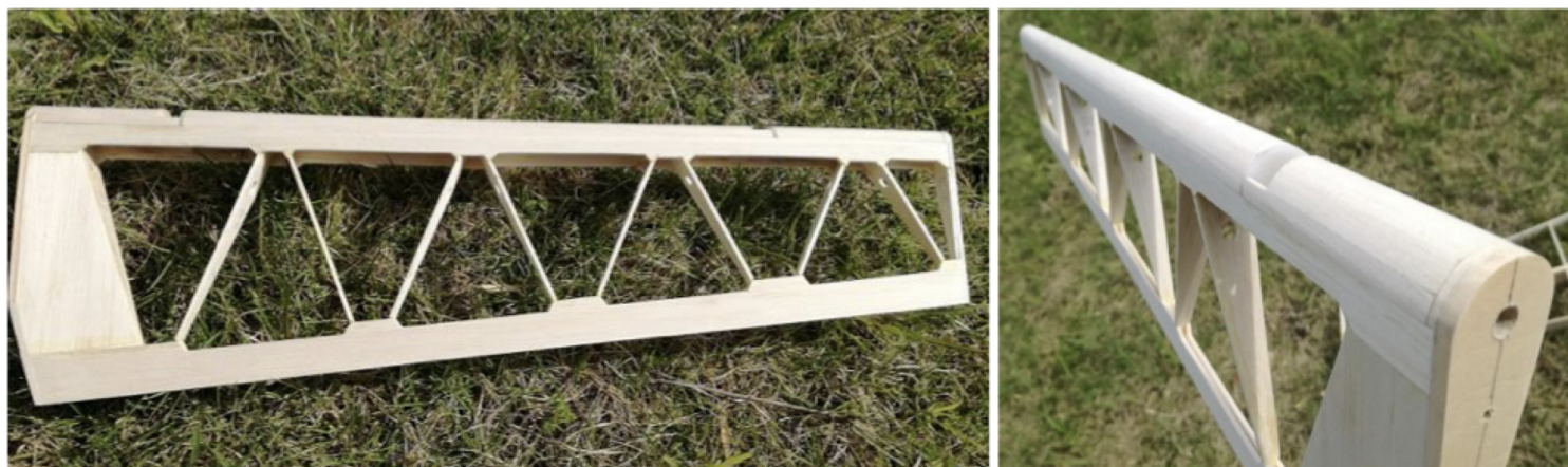
画像23 組立が完了した左エレベータ
