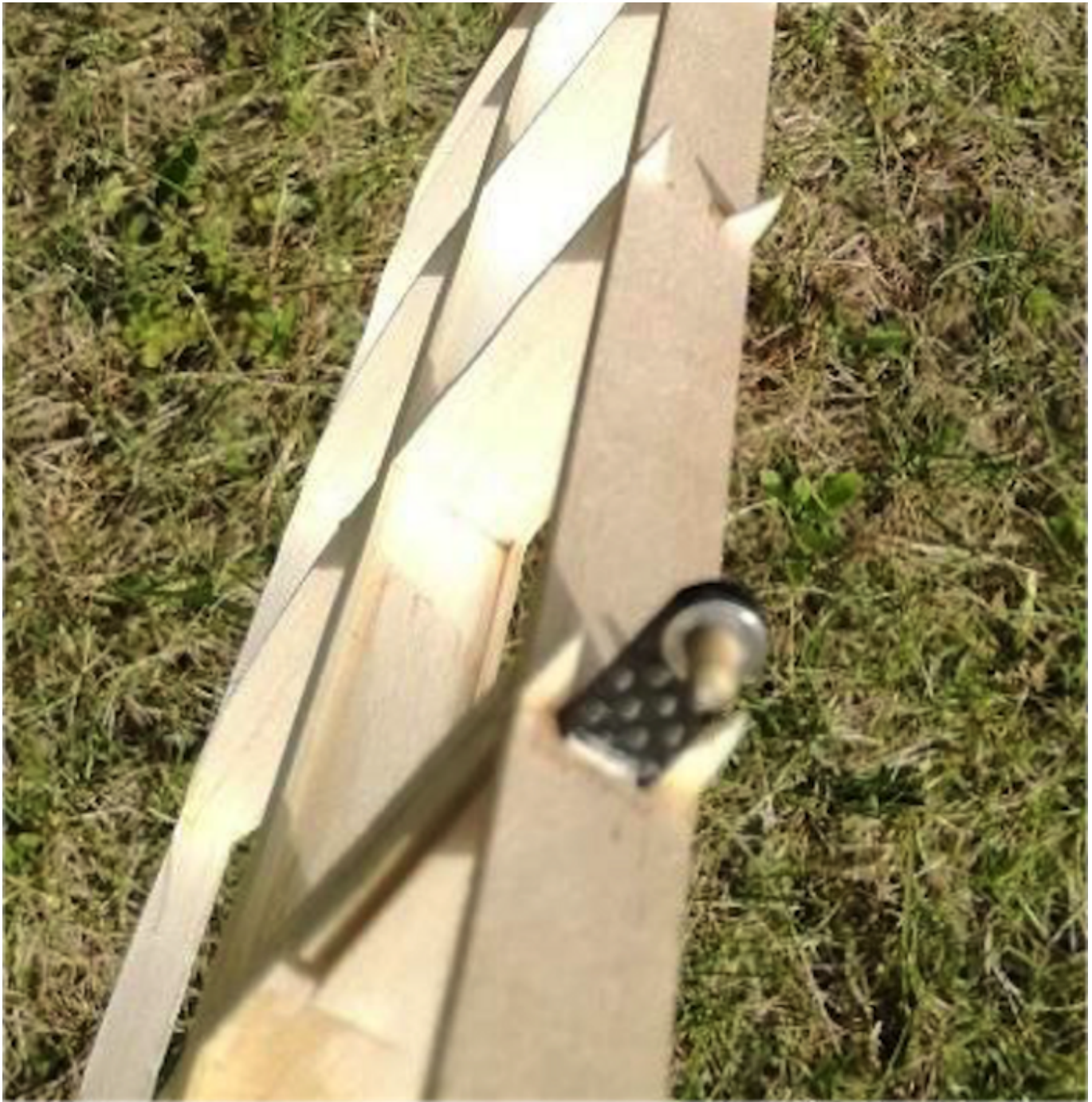
画像25 完成した水平安定板のリブ組み立て
