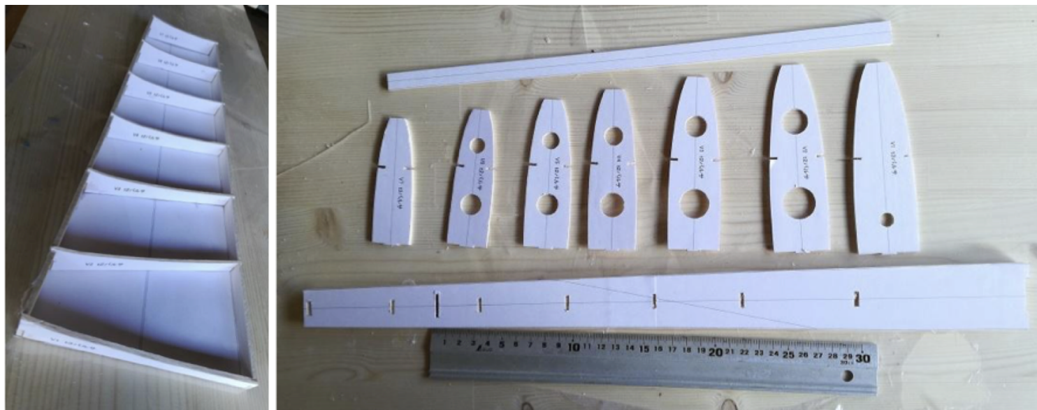
画像19 垂直安定板の組立治具と部品
