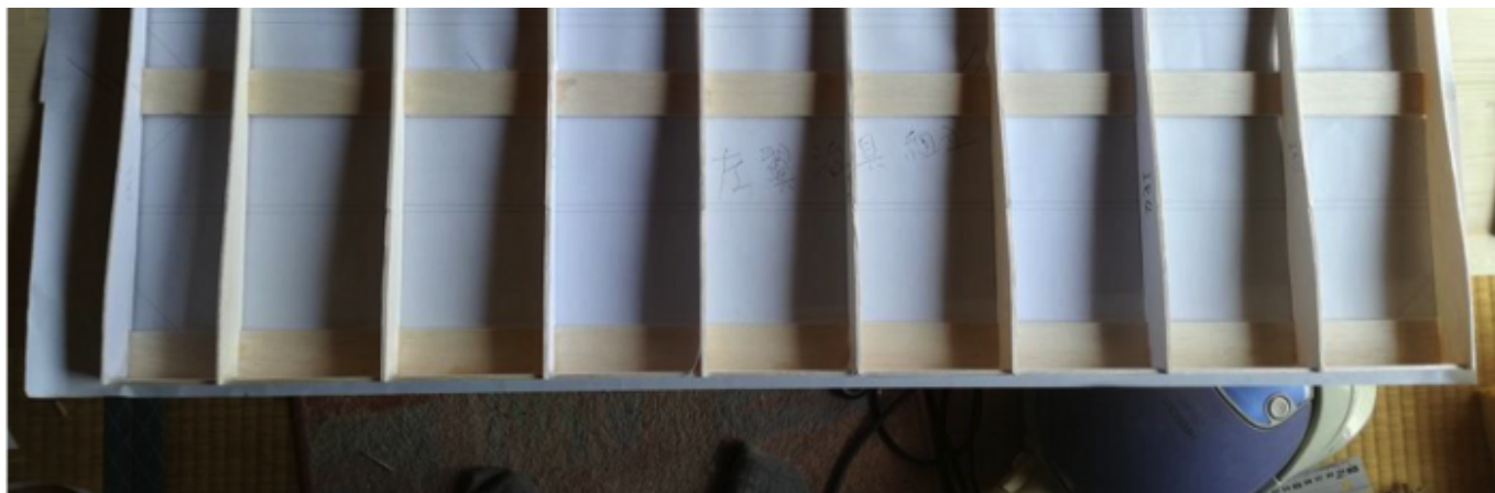
画像9 組みあがった中央翼組立治具
