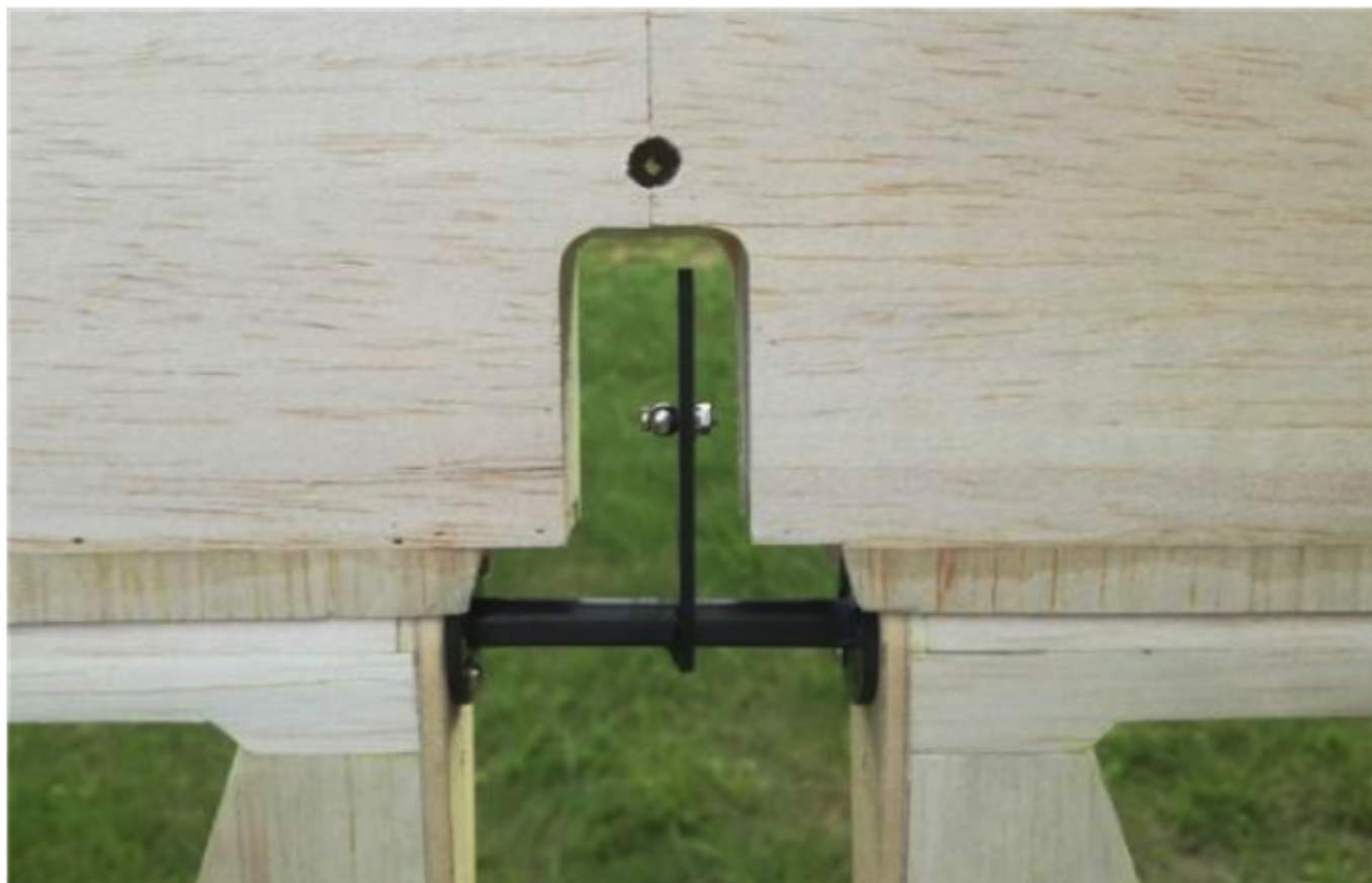
画像28 エレベータ連結部
