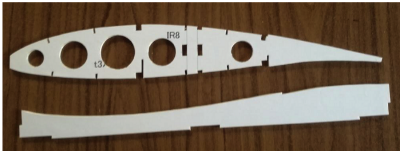
画像8 切り出されたリブと組立治具構成部品
