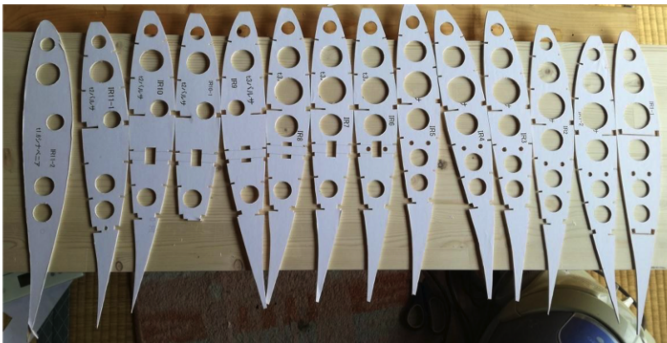
画像10 切り出された中央翼片翼分のリブ
