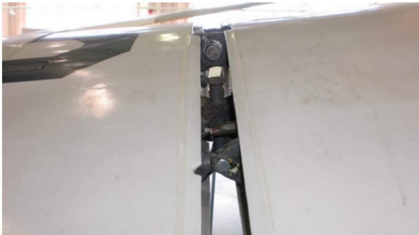
画像3 実機の中央翼と外翼の結合部
